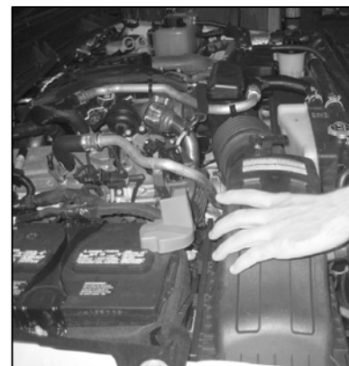
FIG. 2 REMOVE AIR BOX
