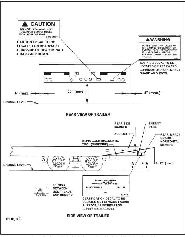
FIGURE 3-8 REAR IMPACT GUARD AND ANTILOCK BRAKE SYSTEM
