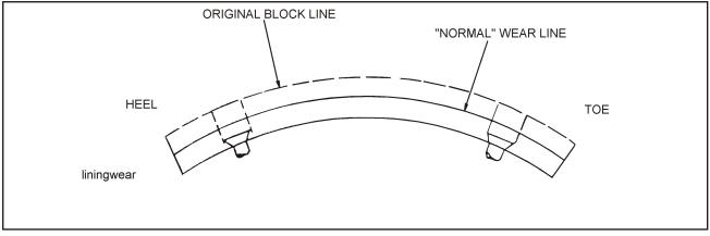
**FIGURE 4-9 BRAKE LINING WEAR**
