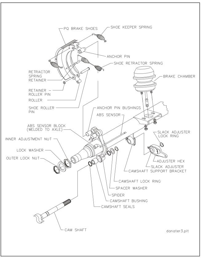
FIGURE 4-10 AXLE AND BRAKE ASSEMBLY
