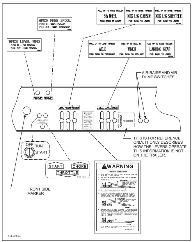
FIGURE 3-2 318C BOEING TRAILER HYDRAULIC CONTROLS
