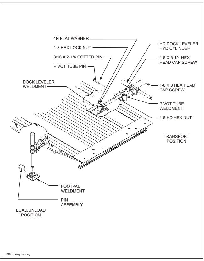
FIGURE 3-3 DOCK LEG (REAR LIFT) CONTROL OPERATION
