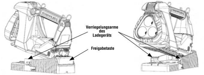
**MONTAGE DES LADEGERÄTS** Das Ladegerät bzw. die Ladestation ist so konstruiert, dass es/sie in vielen Positionen verwendet werden kann. In vorhandenen Anwendungen erlaubt die Baugröße des Ladegeräts einen einfachen Ersatz/Austausch älterer Vulcan®- oder LiteBox®-Ladegeräte.
