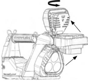
**LADEN DES STRAHLERS** Die Vulcan Clutch® sollte vor Gebrauch voll aufgeladen werden. Stellen Sie die Unterseite des Strahlers in das Ladegerät und lassen Sie ihn zwischen den Verriegelungsarmen einrasten (er muss fest sitzen). Drücken Sie die graue, hintere Verriegelung und drücken Sie den Strahler leicht nach vorne, um die Vulcan Clutch® herauszunehmen.
