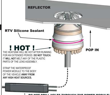
DO NOT DRILL HOLES THROUGH THE POWER MODULE!
